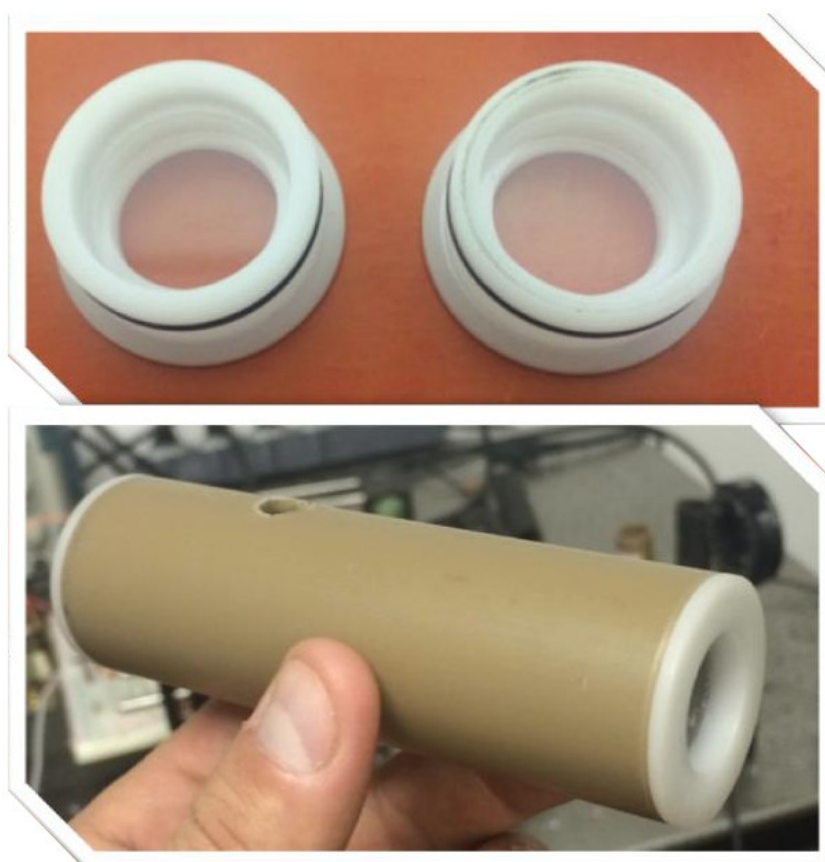
FIGURA D.1 – Esquema do tubo porta amostra para o polarímetro. Fonte (FAUTH, 2017)
